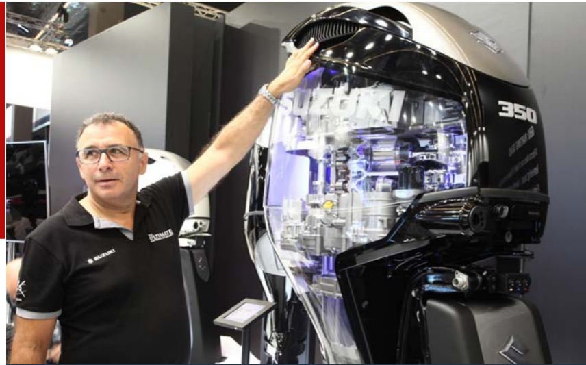
Christophe Vassas, directeur de Suzuki Marine France, pointe du doigt le travail effectué sur les prises d'air du capot.
